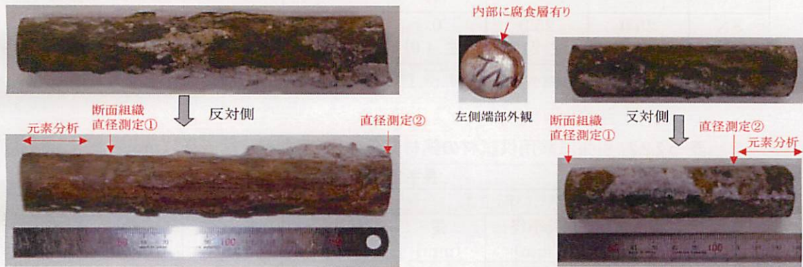
供試材 SF（腐食の激しい）
