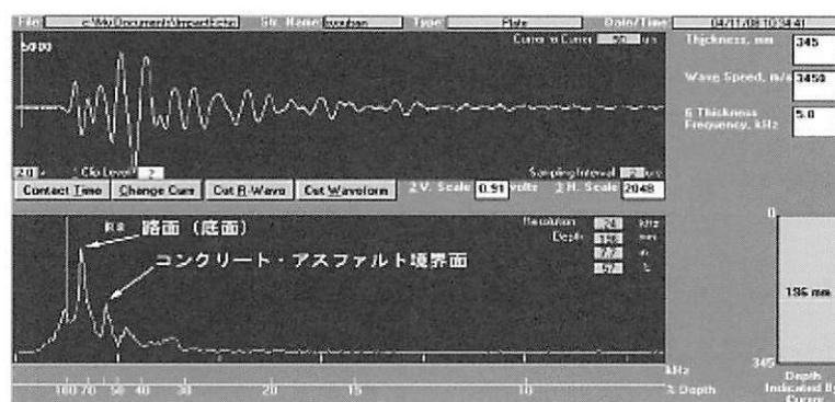
図-2.4.23 床版厚さ測定結果例 (音圧データおよび FFT 処理結果)
