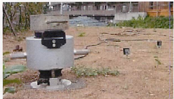
図-4.2 地盤の振動測定イメージと測定の様子 1)
