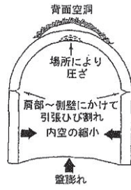
図4 六十里越トンネルの主な変状状況
