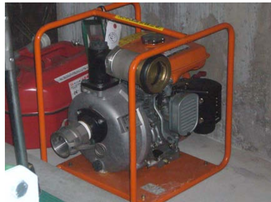
写真 A2-4 浄水場に配備された給水ポンプ
