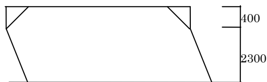
図 2.2.2.1 方杖付き柱の曲げ破壊
