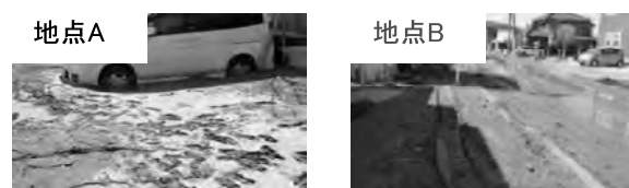
図 2 地点 A、B における噴砂の発生状況 (2011 年 3 月 13 日撮影)
