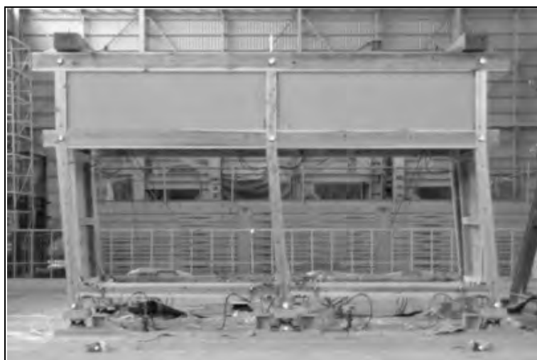
写真 1 3 柱 135mm 角の場合の破壊状況（柱の折損）
