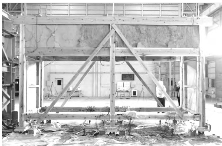
写真 1 2 柱 150mm 角の場合の破壊状況（垂れ壁のせん断破壊）
