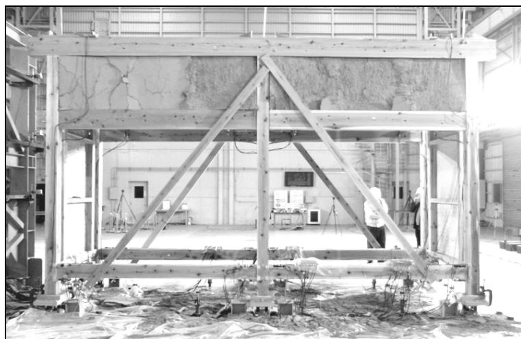
写真 1 2 柱 150mm 角の場合の破壊状況（垂れ壁のせん断破壊）
