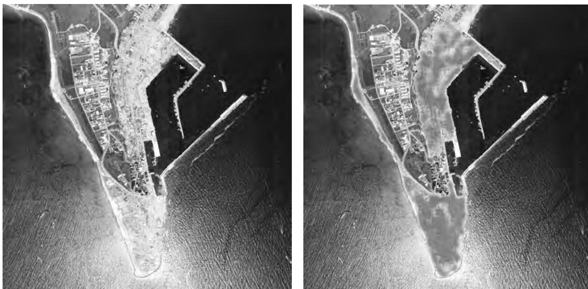
図 3.3-1 航空写真の画像処理による津波被災域の自動抽出(アジア航測(株)提供)
