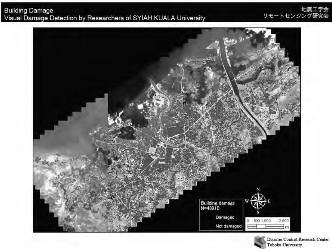
図 3.2-12 IKONOS 画像の比較判読による建物被害の判定結果(越村 2007)
