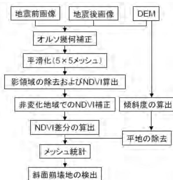
図2.2-13 NDVI による斜面崩壊地の検出の流れ
