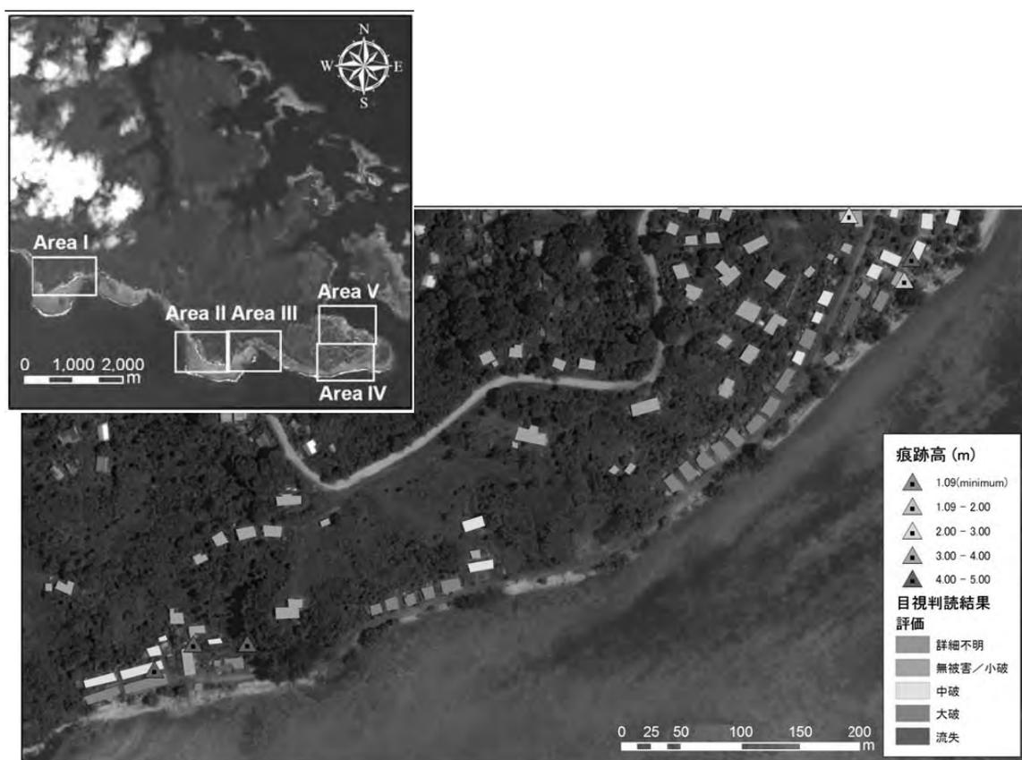
図 3.4-4 QuickBird により地域全体の建物被害判読を行った例(越村 2008)
