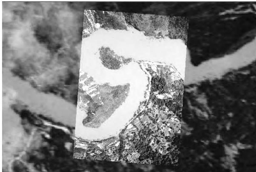
図 2.2-33 FORMASAT 画像を用いてレジストレーションされた無人機画像
