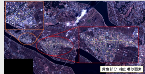
液状化による道路上への噴砂抽出
